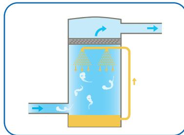
L'air malodorant aspiré dans les bâtiments de la station d'épuration est "lavé" à l'aide de produits chimiques concentrés (eau de javel, acide, ...).
