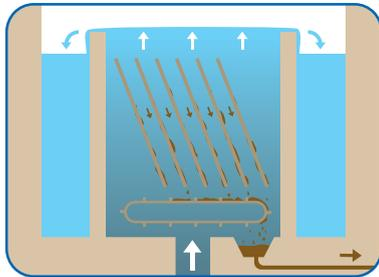
Les matières en suspension dans l'eau se déposent sur les lamelles inclinées puis décantent au fond du bassin. Les matières accumulées au fond du décanteur forment des «boues» 7 et sont extraites périodiquement. L'eau, débarrassée des matières en suspension et des phosphates, s'écoule vers le traitement biologique.
