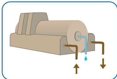
Issues de la décantation 3 et du traitement biologique, 4 les boues sont déshydratées à l'aide de centrifugeuses. Elles sont ensuite chaulées pour être utilisées comme fertilisant par les agriculteurs.
