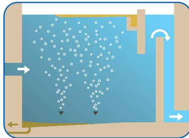
Ils ôtent grossièrement les matières denses et les matières flottantes. Les matières denses (les sables et les graviers) se déposent au fond du bassin tandis que les matières flottantes (les huiles et les graisses) sont remontées en surface grâce à de petites bulles d'air.
