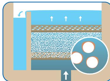
Les bassins d'épuration biologique sont remplis de billes de polystyrène, favorisant la fixation de bactéries. Ces bactéries digèrent la pollution carbonée et azotée pour leur développement. Les bactéries mortes forment des «boues» 7 régulièrement extraites.
